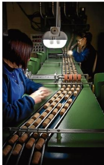
Figura 17. Personal per tria de taps. Classifiquen taps segons la qualitat del suro i defectes.
