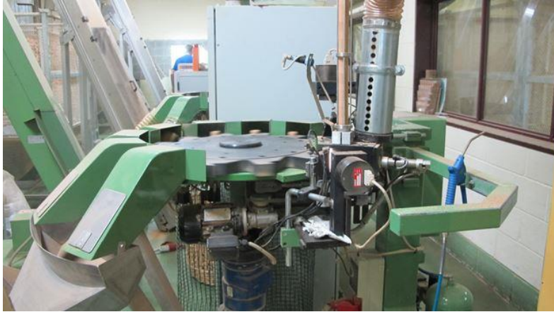
Figura 16. Màquina de tria electrònica. Classifica taps segons la qualitat del suro i defectes.
