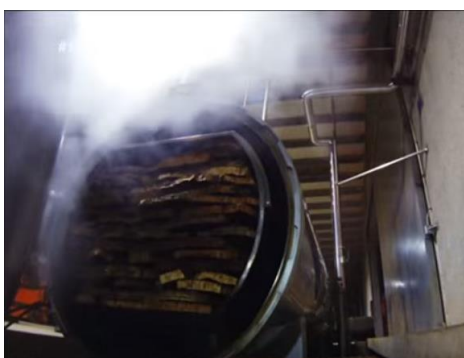
Figura 11. Planxes de suro esterilitzades per autoclau.
