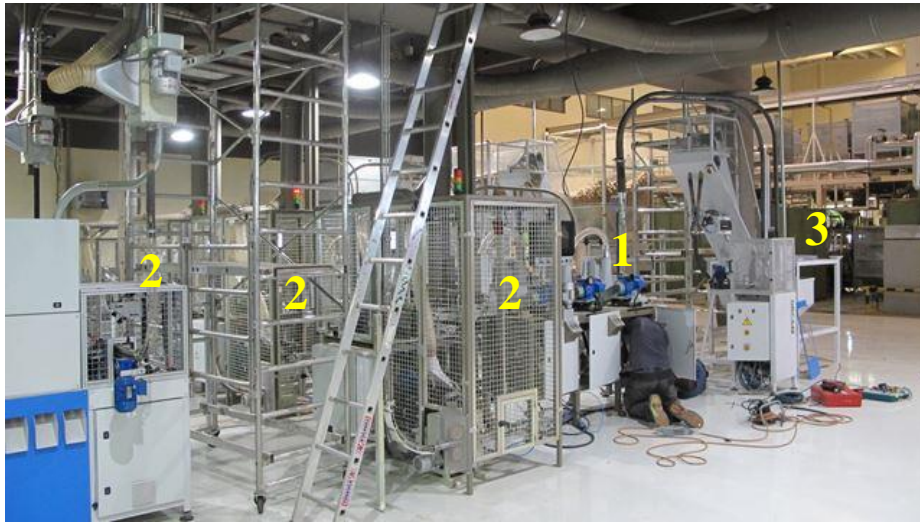
Figura 68. Noves línies de fabricació. Es vol unir les encoladores en el punt 3.
