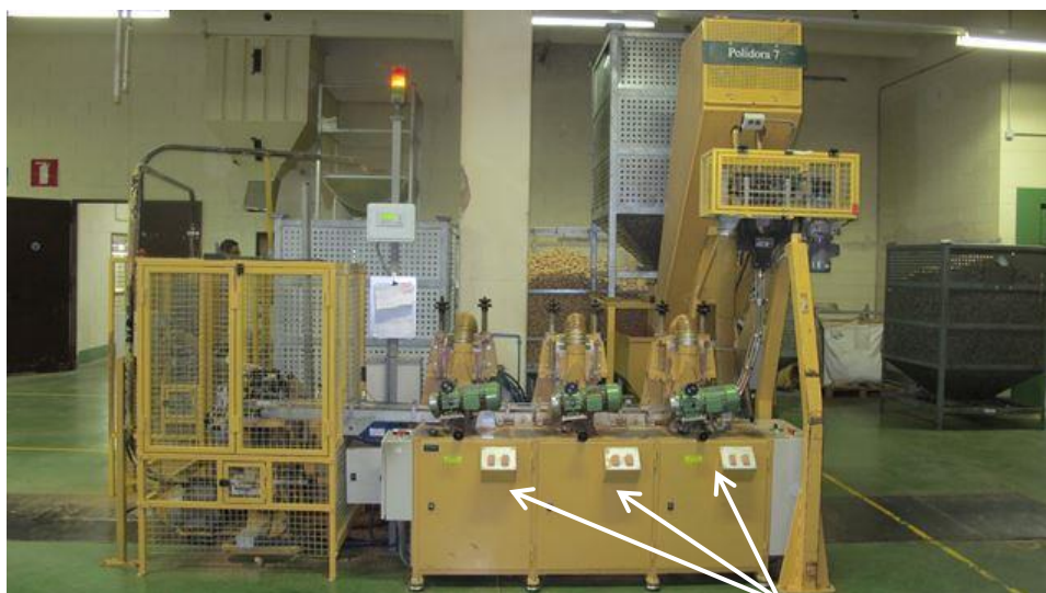
Figura 15. Polidora triple. S'anomena triple per l'acció de rebaixar tres cops.
