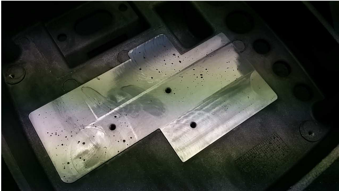
Figura 1: Base per al variador de freqüència – zona de dissipació (peça defectuosa).
