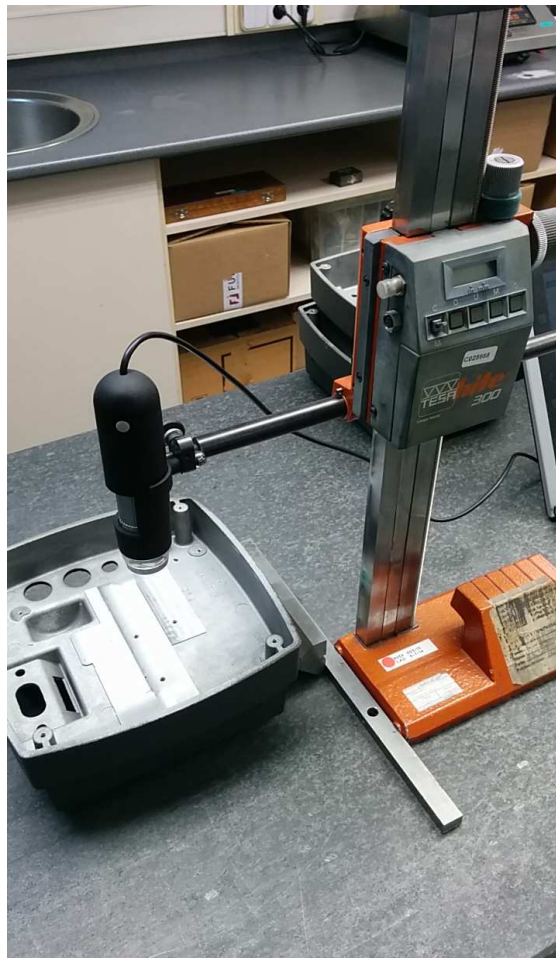
Figura 17: Muntatge experimental per a la obtenció de les imatges
