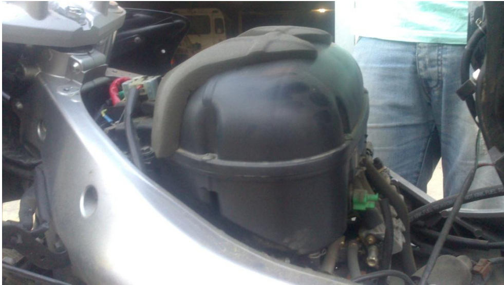
FIGURA C.12 Plenum + filtre original
