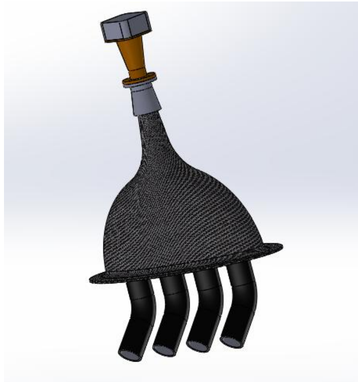
FIGURA 7. Sistema d'admissió complet
