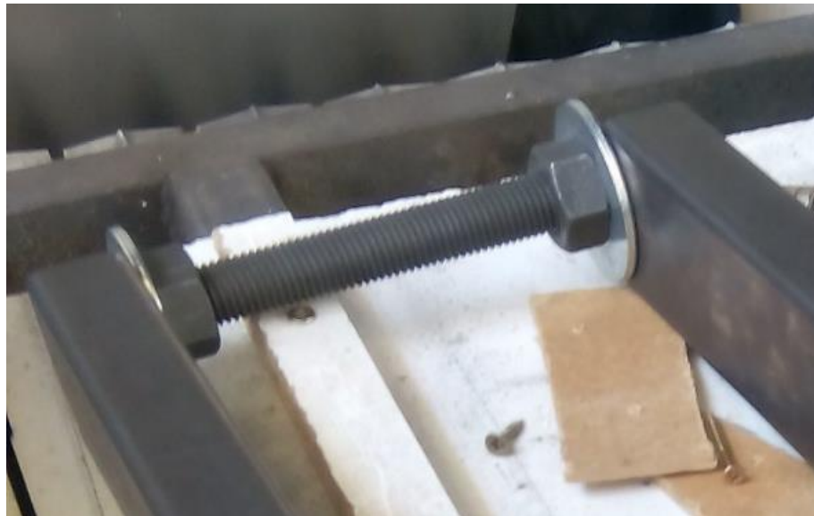
Figura E.13 Mecanisme per vèncer les forces de pressió degudes a l'augment de temperatura
