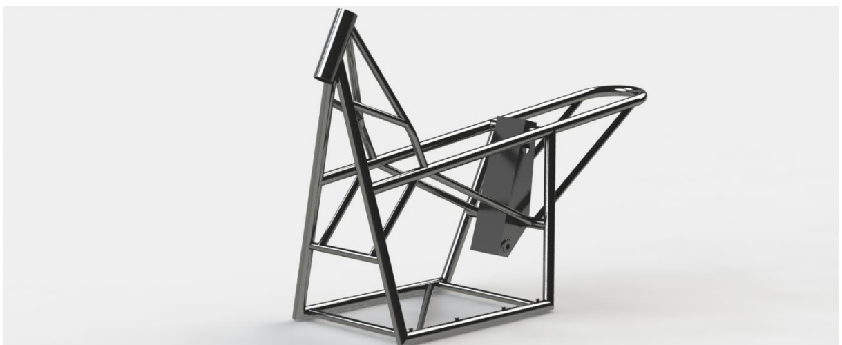
Figura 4. Xassís tubular d'acer dissenyat per la motocicleta elèctrica
