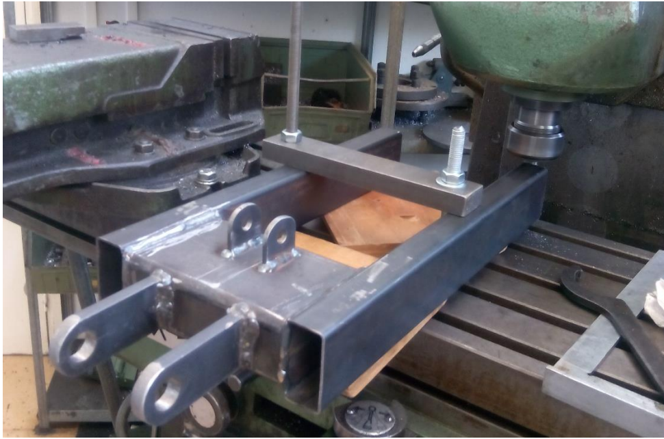
Figura E.15 Refrentat per a fer coincidir les cares a un mateix pla
