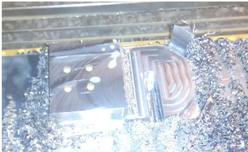
Figura E.16 Mecanitzat dels anclatges mitjançant la fresadora CNC de 3 eixos
