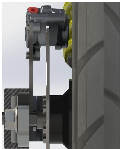
Figura 15. Paral·lelisme entre els diferents components per ajustar la posició del disc de fre i la roda posterior
