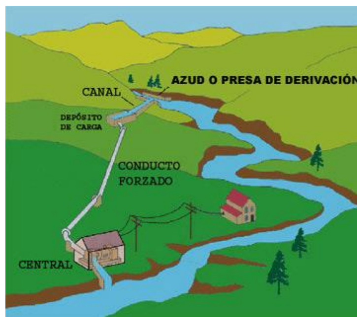
Figura 3. Central hidroelèctrica d'aigua fluent
