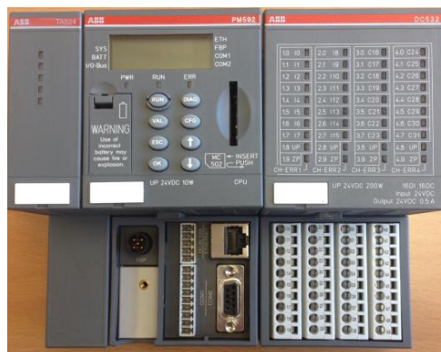
Figura 37. Conjunt PLC + mòdul I/O
