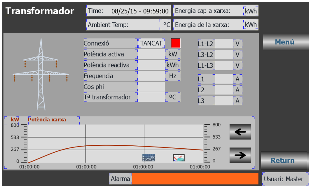
Figura 49. Pantalla SCADA transformador
