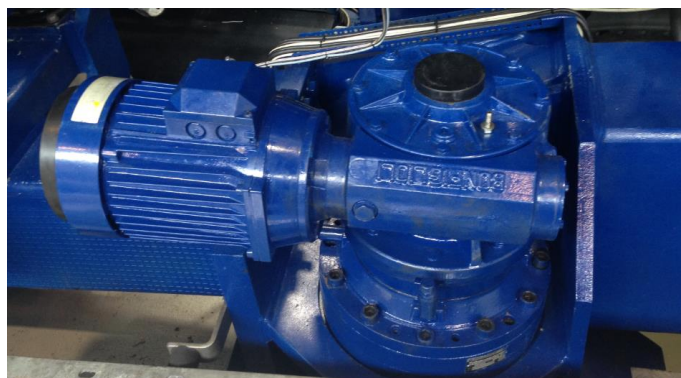
Figura 24. Motor per regular el yaw
