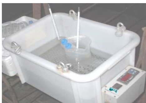
Figura 9. Descongelació dels espermatozoides criopreservats en un bany d'aigua amb diluent de descongelació a 37^{\circ}C (TechnoSperm, 2015)
