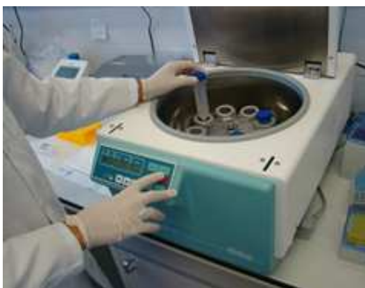
Figura 4. Centrifugació de la fracció rica a 300 \times g durant 1 minut a 16-17^{\circ}\text{C} (TechnoSperm, 2015)
