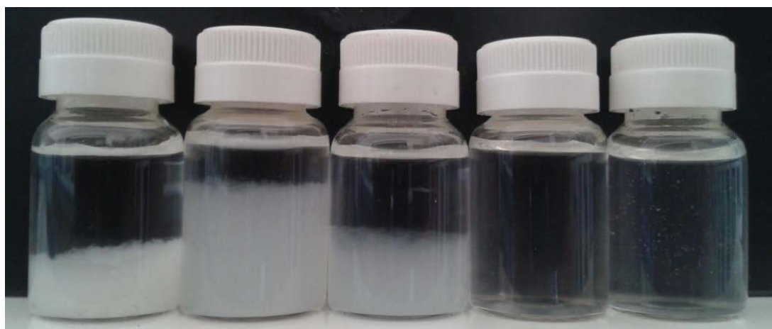
Figura 20. CNF preparadas para este estudio. De izquierda a derecha: CNF-Ac, CNF-Mec, CNF-Enz, CNF-TEMPO.7 y CNF-TEMPO.10
