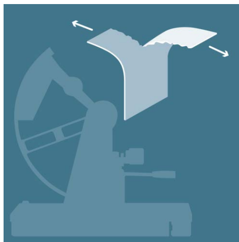
Figura 18. Representación esquemática del ensayo Elmendorf [142]
