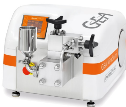
Figura 15. Homogeneizador PANDA Plus utilizado para la desestructuración.
