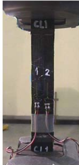
Figura B.40. Assaig de tracció dels FRP (Font: [2])
