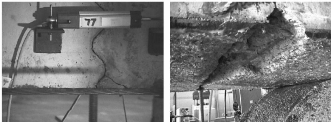
Figura B.17. Detall de la desadhesió del TFC a la biga VD-TFC2; (Esq) Fisuració inicial a la junta; (Dret) Desadhesió del TFC. (Font; [1])
