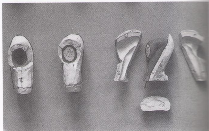
Fig. 3 Elaboración por secciones del molde de fundición de la pierna izquierda
