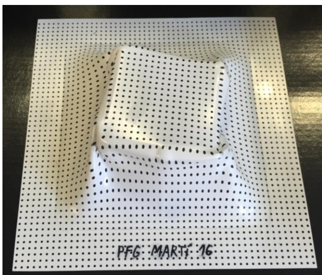
Figura 3.9 Exemple d'experiment realitzat amb TPIF i que ha patit torsió
