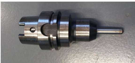
Figura 2.9 Portaeines Weldon amb l'eina de Ø10 col·locada
