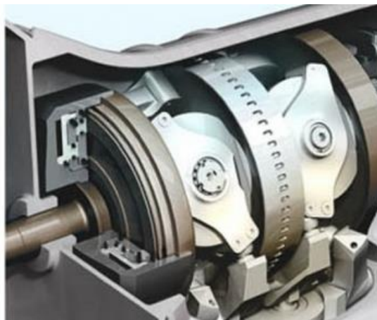
Figura 9. Exemple d'un variador complet (Full TCVT). “www.gizmag.com”
