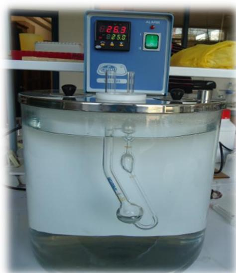
Figure 4.12. Ostwald viscosimeter
