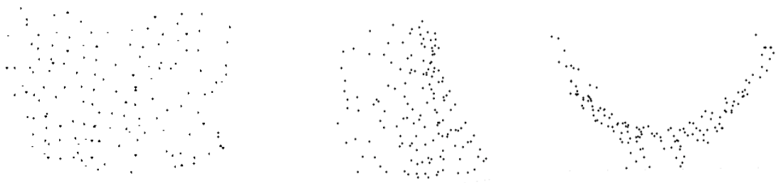
Figura 4.29 Última reconstrucció obtinguda de la seqüència de la màscara. La primera vista representa la part frontal, la segona el perfil i la tercera la part superior.
