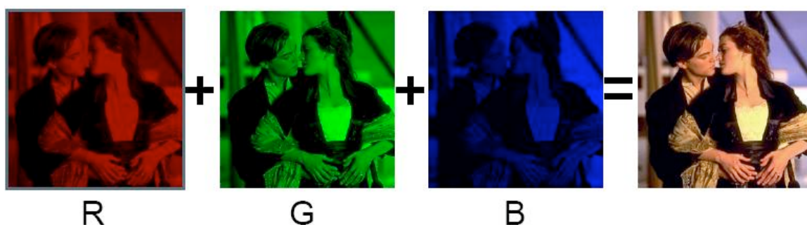
Figura 2.3 Exemple de digitalització en color. Les tres primeres matrius contenen la intensitat de cada color i al final es sumen les matrius per formar la imatge final en color.
