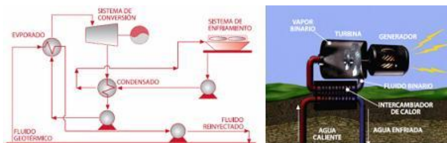
Figura 4.6.15. Esquema planta geotérmica de ciclo binario
