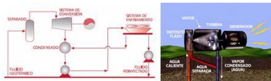
Figura 4.6.14. Esquema de planta geotérmica de ciclo flash
