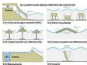
Figura 4.4.11. Clasificación de los convertidores de energías del mar según su principio de captación
