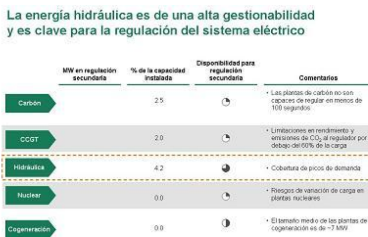
Figura 4.7.16. Contribución a la regulación del sistema eléctrico de las diferentes tecnologías energéticas
