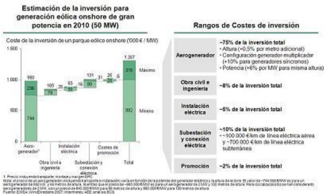
Figura 4.5.7. Costes de inversión de un parque eólico en tierra
