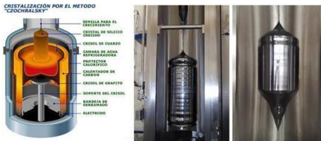
Figura 4.9.7. Cristalización por método Czochralsky
