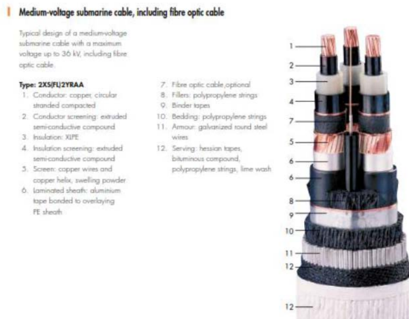
Figura 24: Conductor submarí de 3 conductors més fibra òptica.
