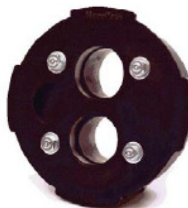
Tapa goma boca sondeo 140/168 Komposit Ø 40 2 tomas Ø 40 con salida adicional de agua en Ø 25 en la tapa de 140. 2 tomas Ø 40 con salida adicional de agua en Ø 32 en la tapa de 168. Resistente a la corrosión. Goma de compresión de la mejor calidad. (Art. 1032-komp, 1033-komp)
