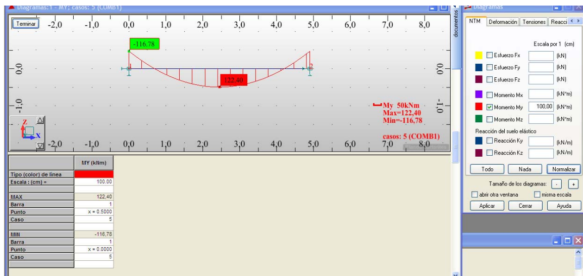
Figura 87- Diagrama de moments en ELU. M_d(-) = -116,78 \text{ kN}\cdot\text{m} , M_d(+) = 122,40 \text{ kN}\cdot\text{m}
