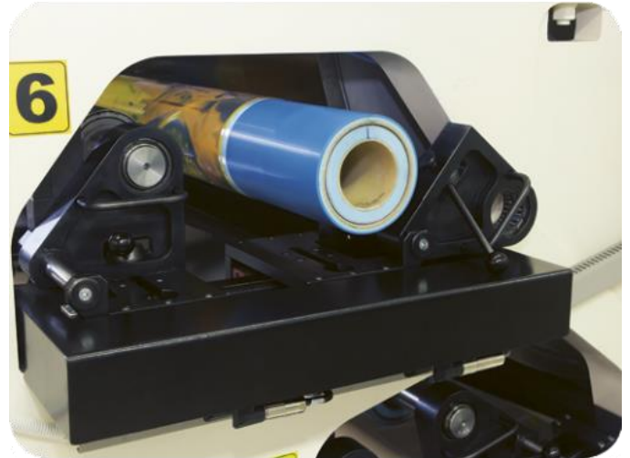
Fig. 11 Conjunt portaclixé + clixé . Font: elaboració pròpia.
