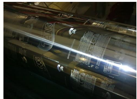
Fig. 15 Cilindre gravat de rotogravat. Font: Comexi Group
