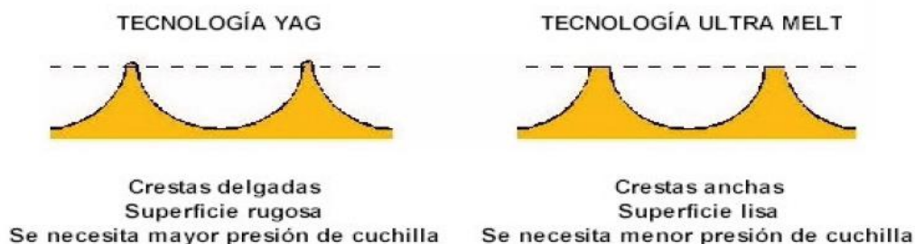
Fig. 118 Formes de les cel·les de l'anilox. Font: Apex
