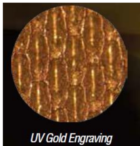
Fig. 122 Imatge de la forma de l'obertura anilox. Font: Praxair
