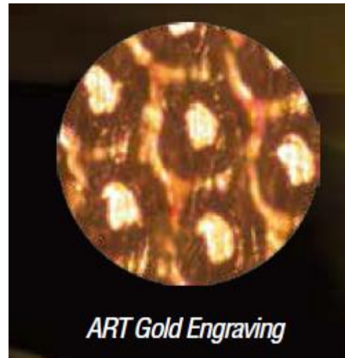
Fig. 123 Forma de l'obertura de l'anilox. Font: Praxair
