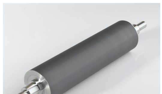
Fig. 10 Anilox o cilindre gravat. Font: elaboració pròpia.
