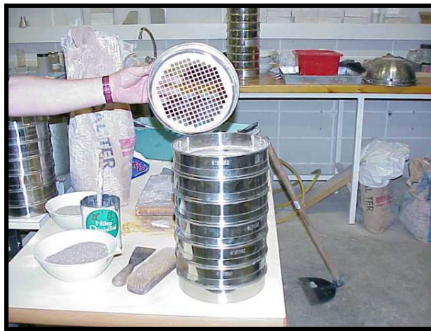
FIG. TAMISSADORA PER MESURAR LA GRANULOMETRIA DELS ÀRIDS
