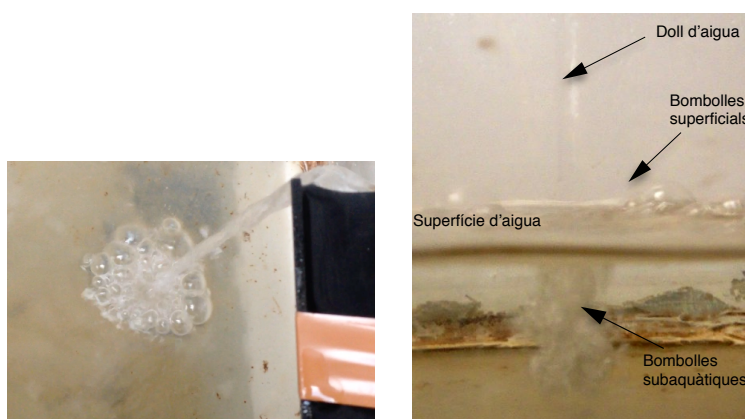
Figura 13. Bombolles produïdes per l'impacte del doll d'aigua
