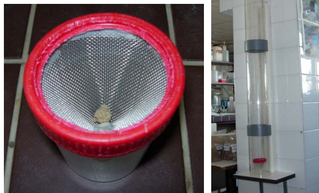
Figura 25. Con de malla metàl·lica amb l'agregat col·locat a la base del con i aparell per al Drop Test.
