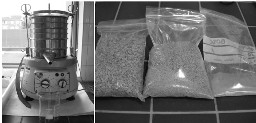
Figura 20. Aparell per tamisar i les fraccions granulomètriques obtingudes del tamisat.
