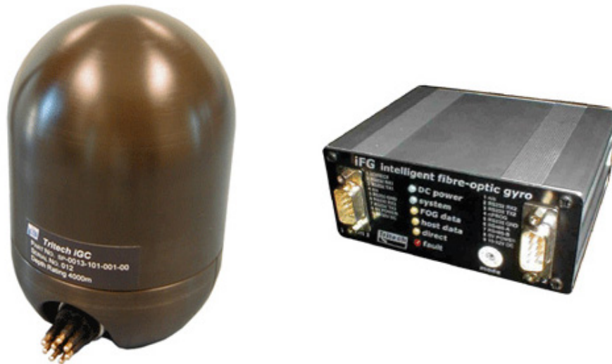
Figura 2: La unitat inercial iGC (esquerra) i el giròscop de fibra òptica iFG (dreta).
