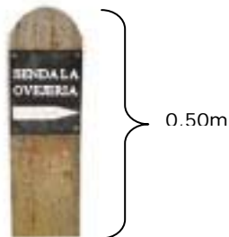
Figura 11. croquis y medidas de la estaca. Fuente: ViaNatura, 2008
