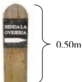
Figura 4. croquis y medidas de la estaca.
