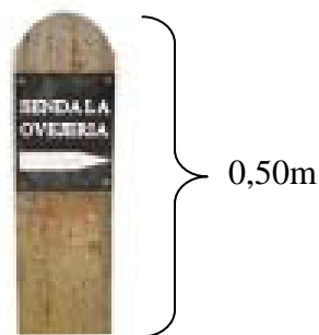
Figura 6. croquis y medidas de las estacas
