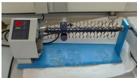
Figura 2: Agitació dels tubs que contenen la dissolució 0,5 M de A336 en CHCl 3 i la solució salina 2 M.
