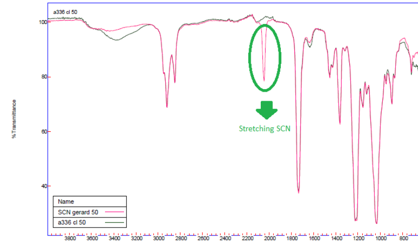
Figura 11: Espectres d'IR superposats per a les membranes amb un 50% de A336-(Cl) i A336-(SCN).
