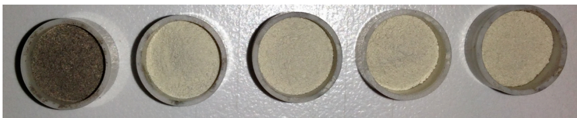
Figura 7.24 – Evolució del color de la mostra des de l'inici fins a 900°C (Començant per l'inicial i acabant pel final, d'esquerre a dreta).
