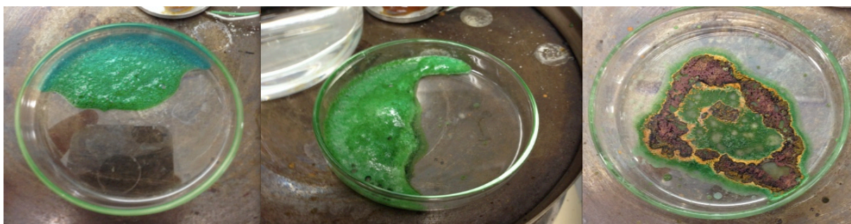
Figura 6.10 – Productes obtinguts dels tres tractaments tèrmics damunt la placa. El de l'esquerre a 100°C, el del mig a 150°C i el de la dreta a 200°C.
