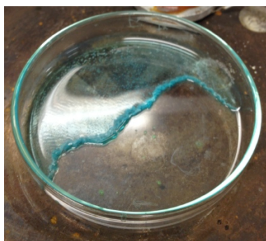
Figura 6.9 – Dissolució abocada a la càpsula circular de vidre per fer el tractament tèrmic damunt la placa calefactora
