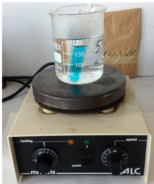
Figura 6.8 – Escalfament de la dissolució damunt la placa calefactora a 80^\circ\text{C}
